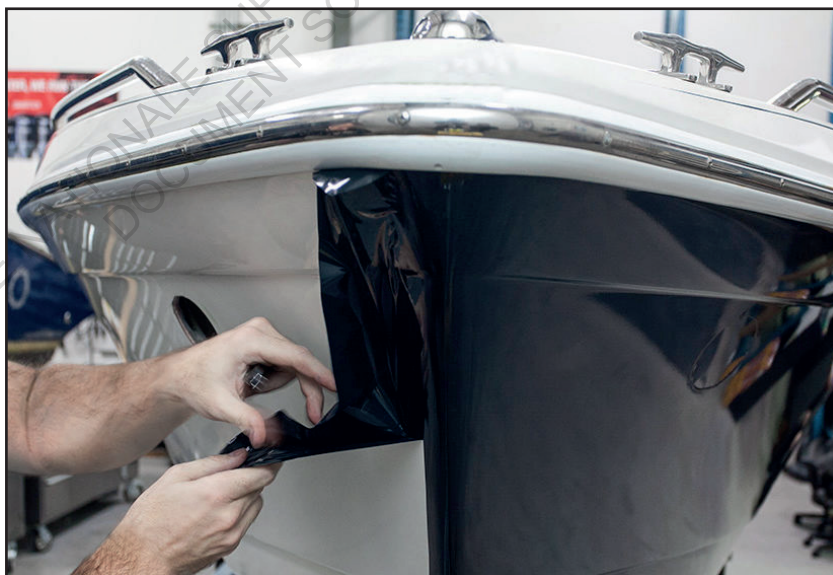
Photo de «total covering» - pose d'un film thermoformable sur une coque de bateau
