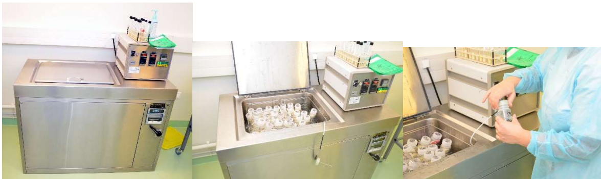
Figure 7. Pasteurisateur utilisé au lactarium du CHU d'Amiens.
