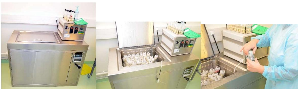
*Figure 7. Pasteurisateur utilisé au lactarium du CHU d'Amiens.*
