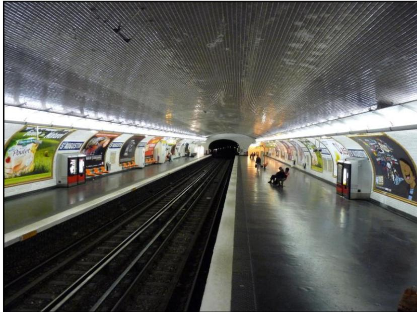
**Figure 18 : Configuration de quai de métro « face à face »
