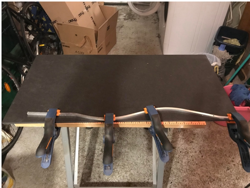
Figure 7 : reproduction de la courbure de la tige en acier sur une plaque de bois MDF
