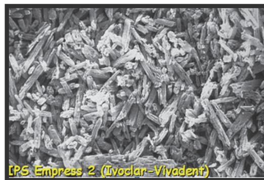
Photo 29 : Microphotographie en microscopie électronique à balayage de disilicate de lithium (Dejou J., Société francophone de biomatériaux dentaires) 114
