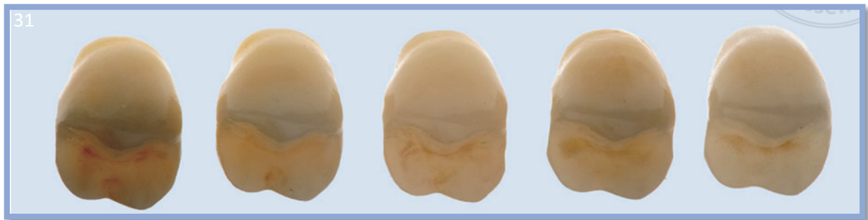
Photographie 31 : Comparaison des différents matériaux sur table lumineuse (de gauche à droite : 1 ère , 2 ème , 3 ème génération, disilicate de lithium LT, HT) ; (Stawarczyk et al., Quintessence international)
