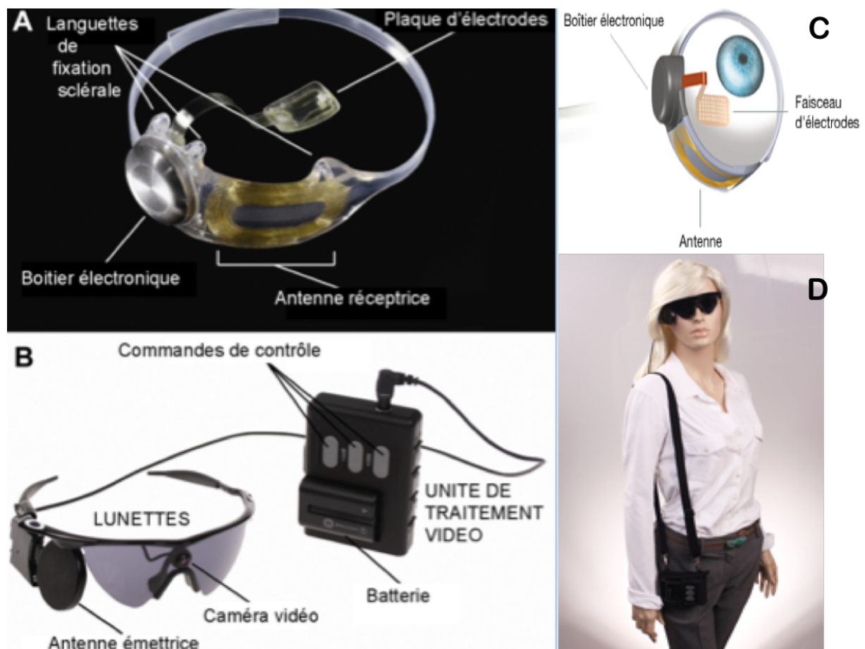
Figure 1: Description générale de l'implant ARGUS II. A. partie implantable, B. dispositif externe, C. schéma de la localisation de la partie implantable, D. exemple de dispositif externe porté.
