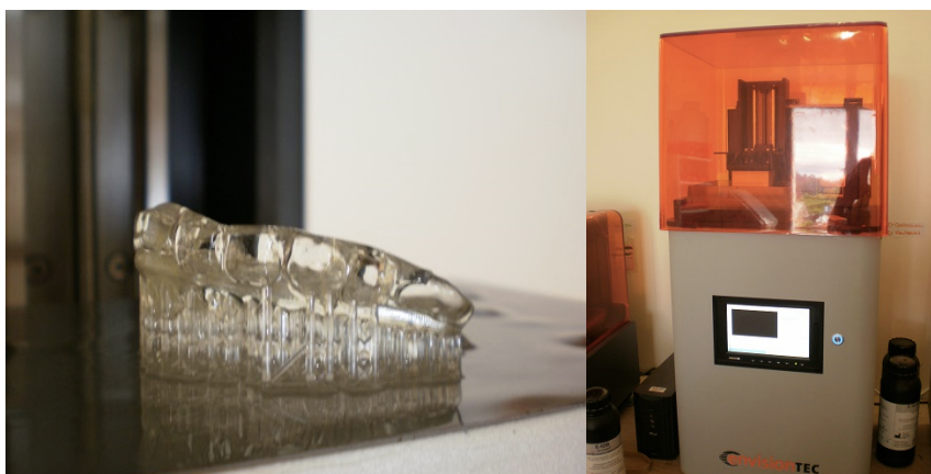
Figure 57: vue d'ensemble de la gouttière et préparation du fichier dans le logiciel d'impression Envisiontec
