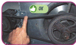
Courroie en bon état et correctement tendue : OK
