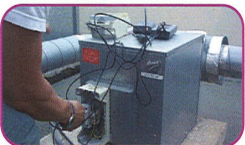
Mesure de l'intensité avec un ampèremètre ou de la puissance électrique avec un wattmètre
