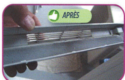
Mousse retirée, passage d'air normal
