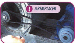
Courroie très usée, craquelée et détendue : à remplacer !
