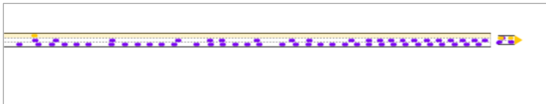
Figure 37 : Rabattement des véhicules de la voie de droite vers la voie du milieu, cas de simulation avec \mu=3000 veh/h et VR2+ activée 20 min après le début. Capture d'écran SymuPlayer prise à 1h15 de simulation
