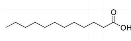
Figure 6 : Structure chimique de l'acide laurique (CH 3 -(CH 2 ) 10 -COOH)
