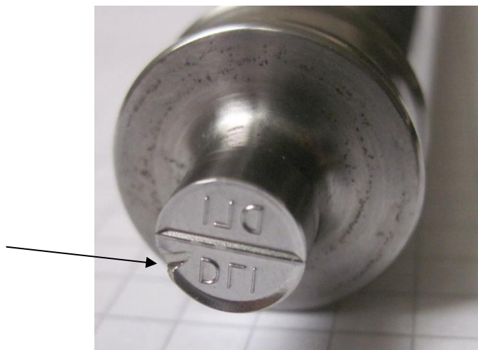
FIGURE 27: CREATION D'UN DEFAUT SUR LA PARTIE ACTIVE DU POINÇON
