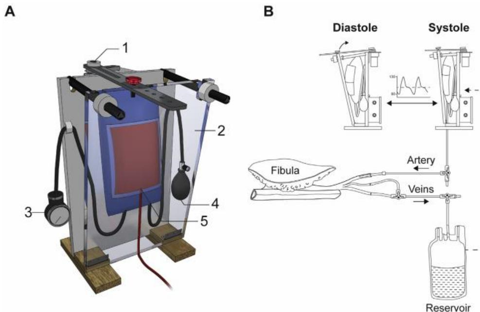
**Figure 17 : Dispositif expérimental de pompe permettant une perfusion de lambeau (A).** Une plaque en verre (2) est poussée contre la poche de sang au moyen d'un bras mécanique (1). La poche de sang est dans une manchette gonflée dont la pression est réglable (4). **B :** schéma du montage expérimental avec un lambeau libre de fibula. Le sang veineux est collecté dans un réservoir mais pas réinjecté. D'après Wolff et al, 2016<sup>93</sup>.
