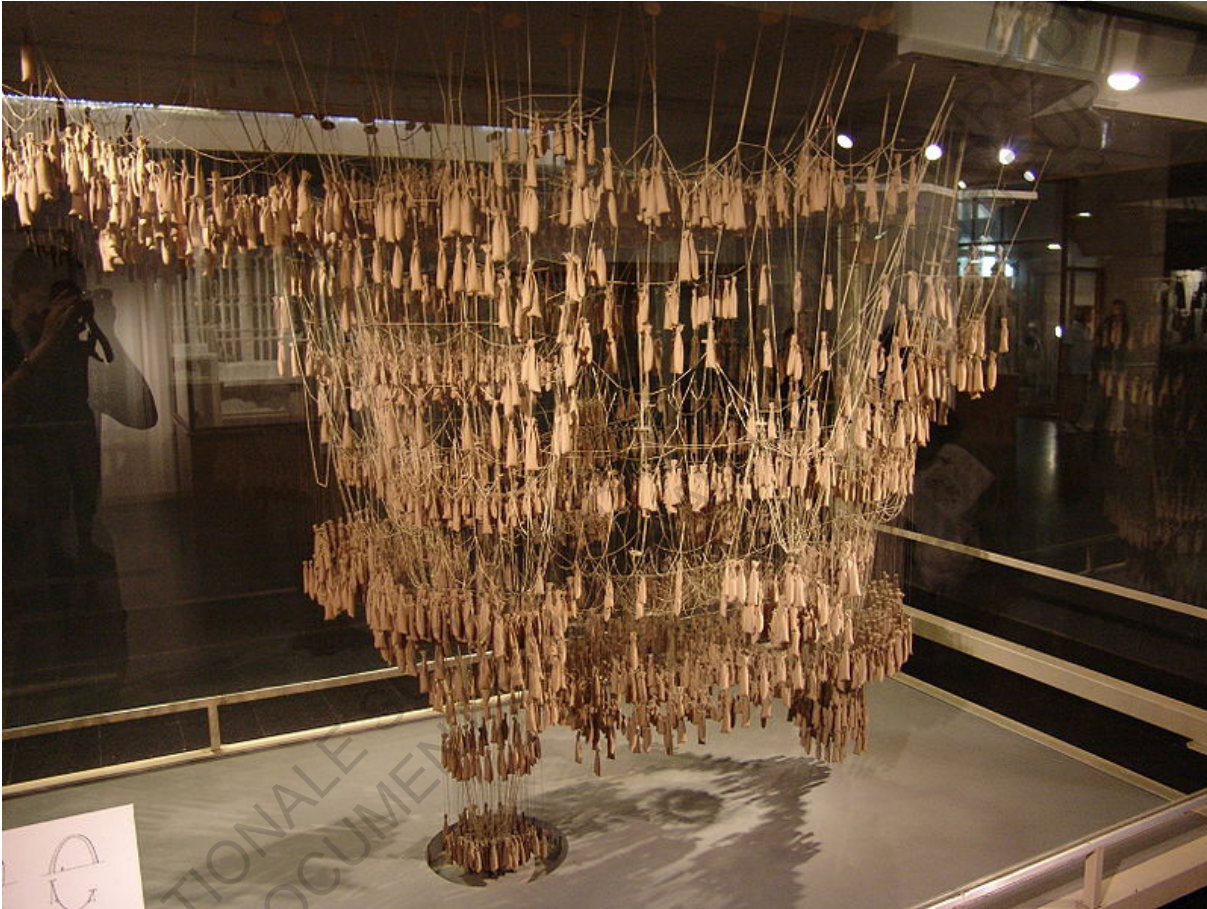
Maquette polyfuniculaire utilisée pour la Sagrada Familia Source : clg-leo-ferre-barcelone2014.eklablog.com
