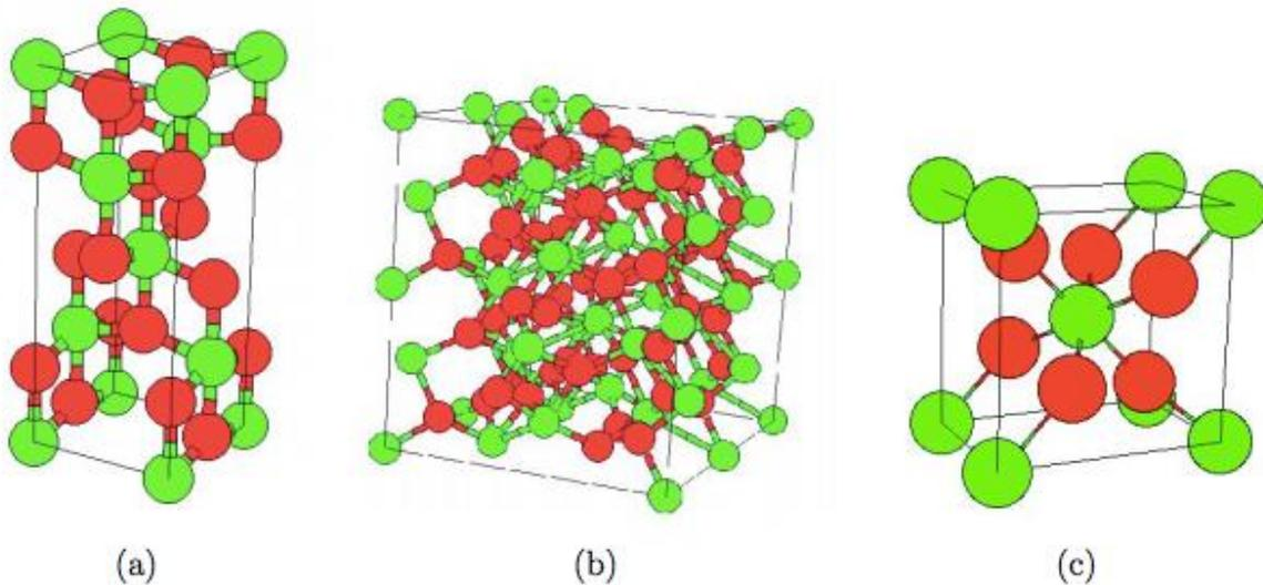
Fig 2 : Structures cristallographiques de TiO<sub>2</sub> : (a) anatase, (b) brookite, (c) rutile. En vert Ti<sup>4+</sup> et en rouge O<sup>2-</sup>.
