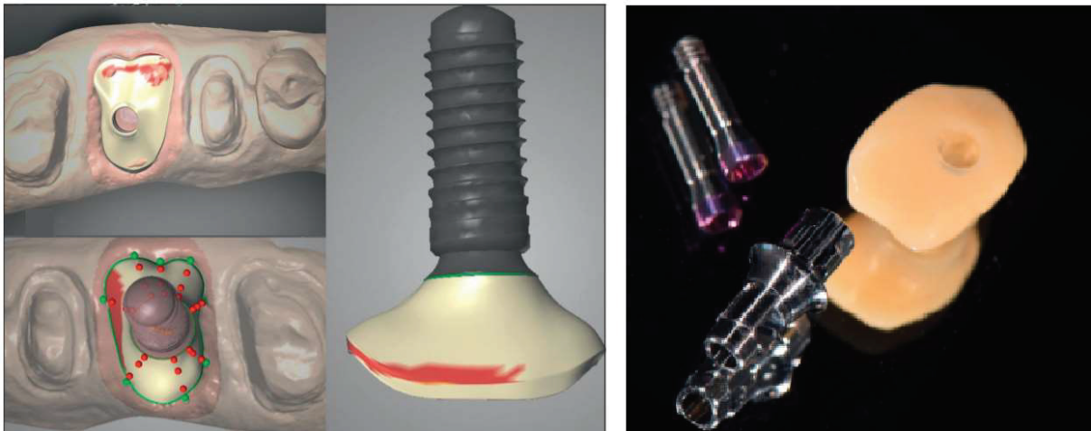
Figure 23 : image illustrant la modélisation du pilier SSA (à gauche) et photographie du pilier SSA usiné (à droite).
