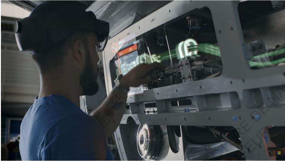
Ci-dessus : Une mise en scène de l'assistance au montage à l'aide du HoloLens 2 de Microsoft.
