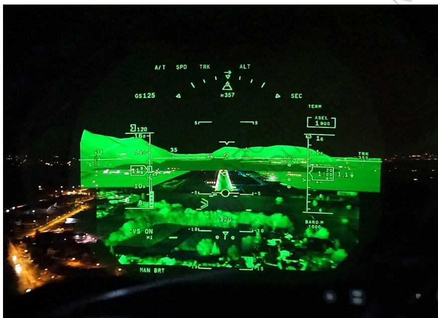
Ci dessus : Vue de nuit au travers du FalconEye lors d'un atterrissage. L'on aperçoit aisément la piste d'atterrissage et les relief, invisible sans le HUD
