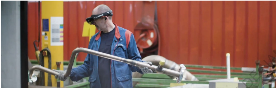
Ci dessus : Un chaudronnier inspecte une pièce de tuyauterie à l'aide du HoloLens FORGE de Microsoft
