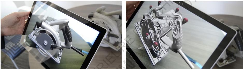
Ci-dessus, deux captures d'écran d'une présentation d'une scie circulaire, servant de modèle cible. L'application détecte la scie et cale par-dessus son double virtuel. Seul un décalage au niveau du câble d'alimentation subsiste, le reste est parfaitement aligné.
