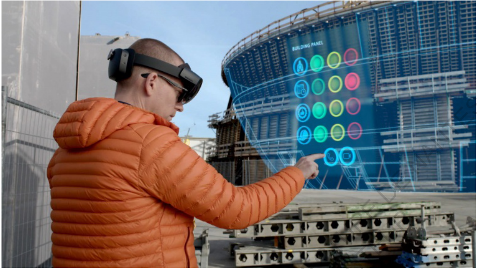
Ci-dessus : Capture d'écran de la vidéo de présentation du Microsoft faisant apparaître le chantier du Beijmans Van Beuningen et l'hologramme BIM superposé sur la structure.
