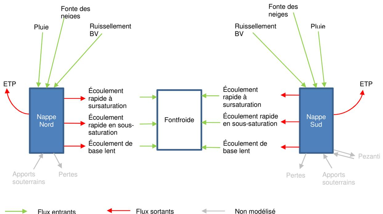
Figure 26 : Conceptualisation du modèle : flux et réservoirs
