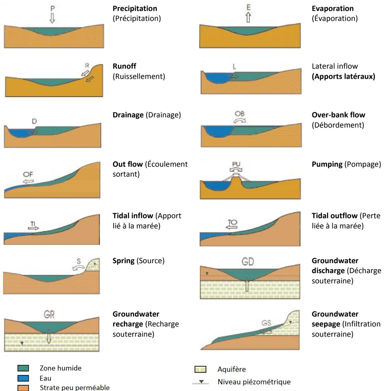
**Figure 3 : Mécanismes de transfert d'eau dans les zones humides (d'après Acreman et Miller, 2006)**
