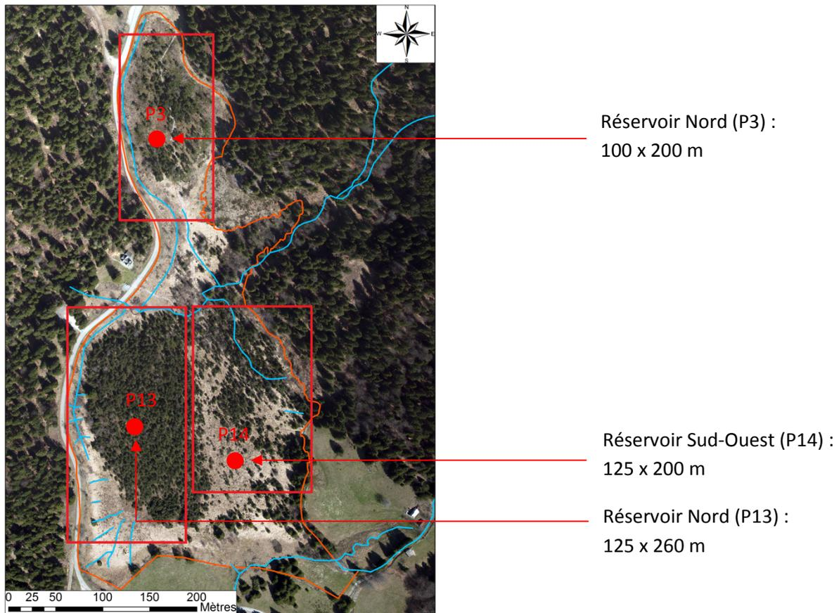
Figure 35 : Les trois surfaces de modélisation des écoulements
