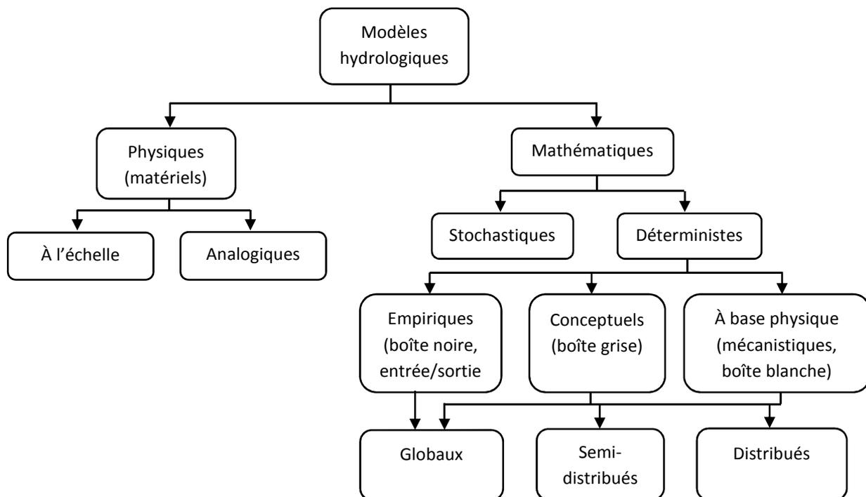
*Figure 9 : Typologie des modèles hydrologiques (d'après Duranel, 2016)*
