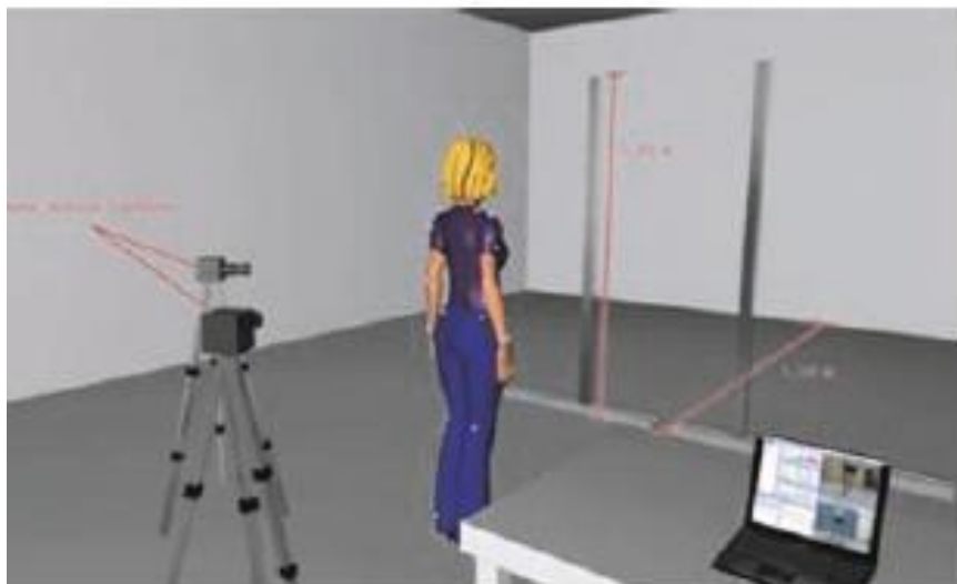
Figure 12. Installation expérimentale de passabilité d'ouverture (85).
