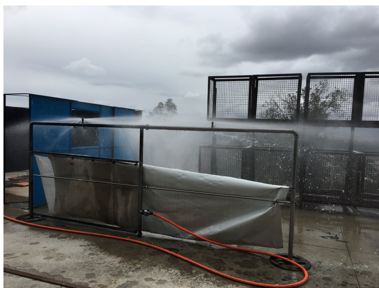
Figure 69 Système de projection d'eau. Source M. Prête, 2018
