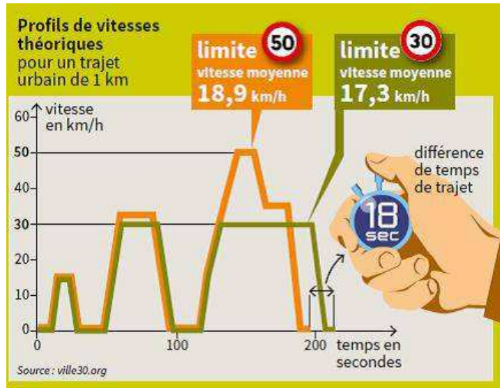
Figure 41: Comparaison des temps de trajets selon les limitations de vitesses en milieu urbain - Ville à 30.org
