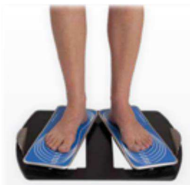
Figure 7. Position normalisée des pieds sur plateforme stabilométrique (normes AFP 85)
