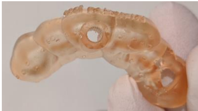
Figure 33 Guide débarrassé des tuteurs : tube de guidage (à gauche) et fenêtre (à droite) visibles
