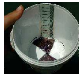
Figure 19 : Outils de mesure du Secchi avec disque de Secchi en fond. RATHO. 13/06/2019. Lucile Delorme
