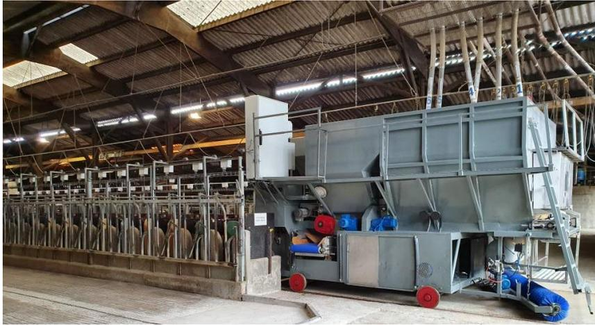
**Figure 1** : Photographie des auge individuelles (à gauche) et de l'automate de distribution de l'alimentation (à droite) installés à l'IEPL
