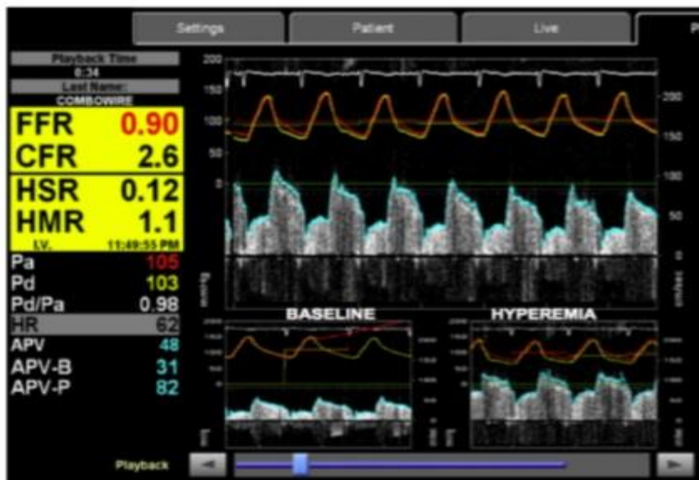
Figure 18 : Représentation des mesures invasives de CFR, HSR et HMR au moyen d'un guide doppler intra coronaire.
