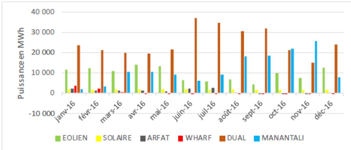
Figure 8 : Répartition de charge entre les centrales en 2016
