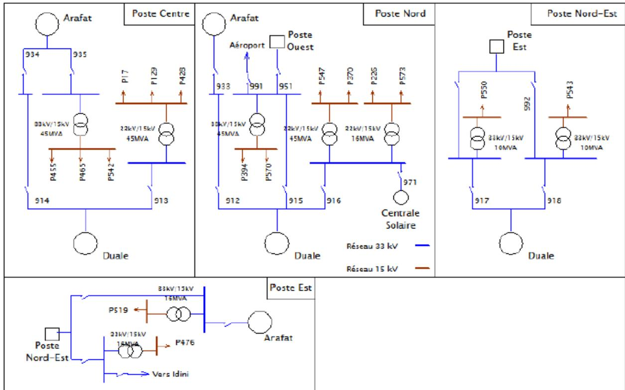
Figure 16 : Schéma unifilaire des postes MT 33/15 kV
