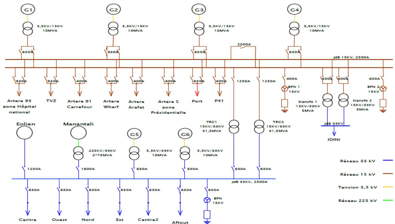
Figure 10 : Schéma unifilaire de la poste Arafatt 1
