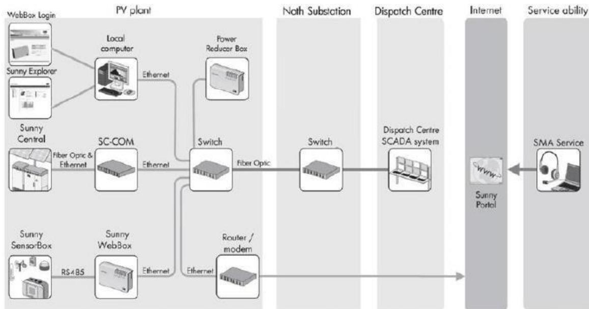
Figure 27 : Illustration de communication entre la centrale Solaire
