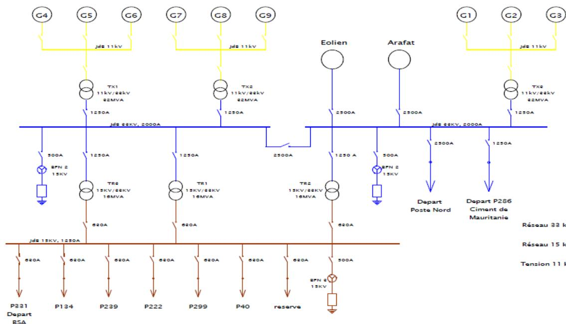
Figure 14 : Schéma unifilaire du post centrale Wharf
