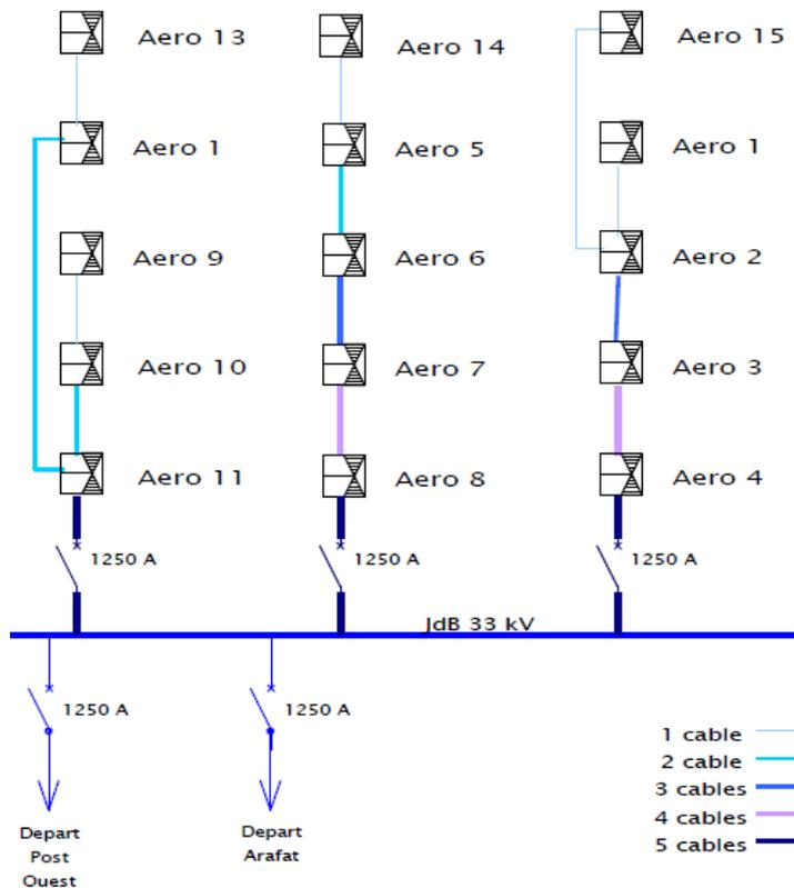
Figure 11 : Schéma unifilaire de la centrale Eolienne
