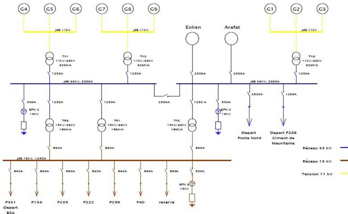
Figure 15 : Schéma unifilaire des postes Duale
