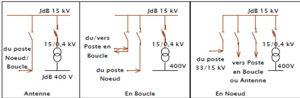
Figure 15 : Structure des postes de distribution 15/0,4 kV
