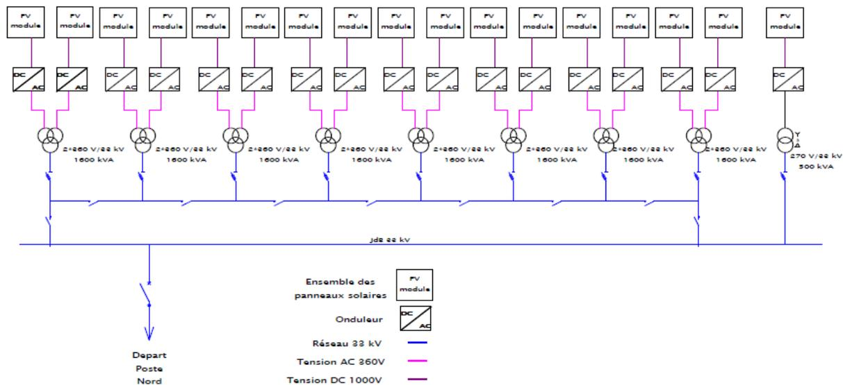
Figure 12 : Schéma unifilaire de la centrale Solaire 15 MW
