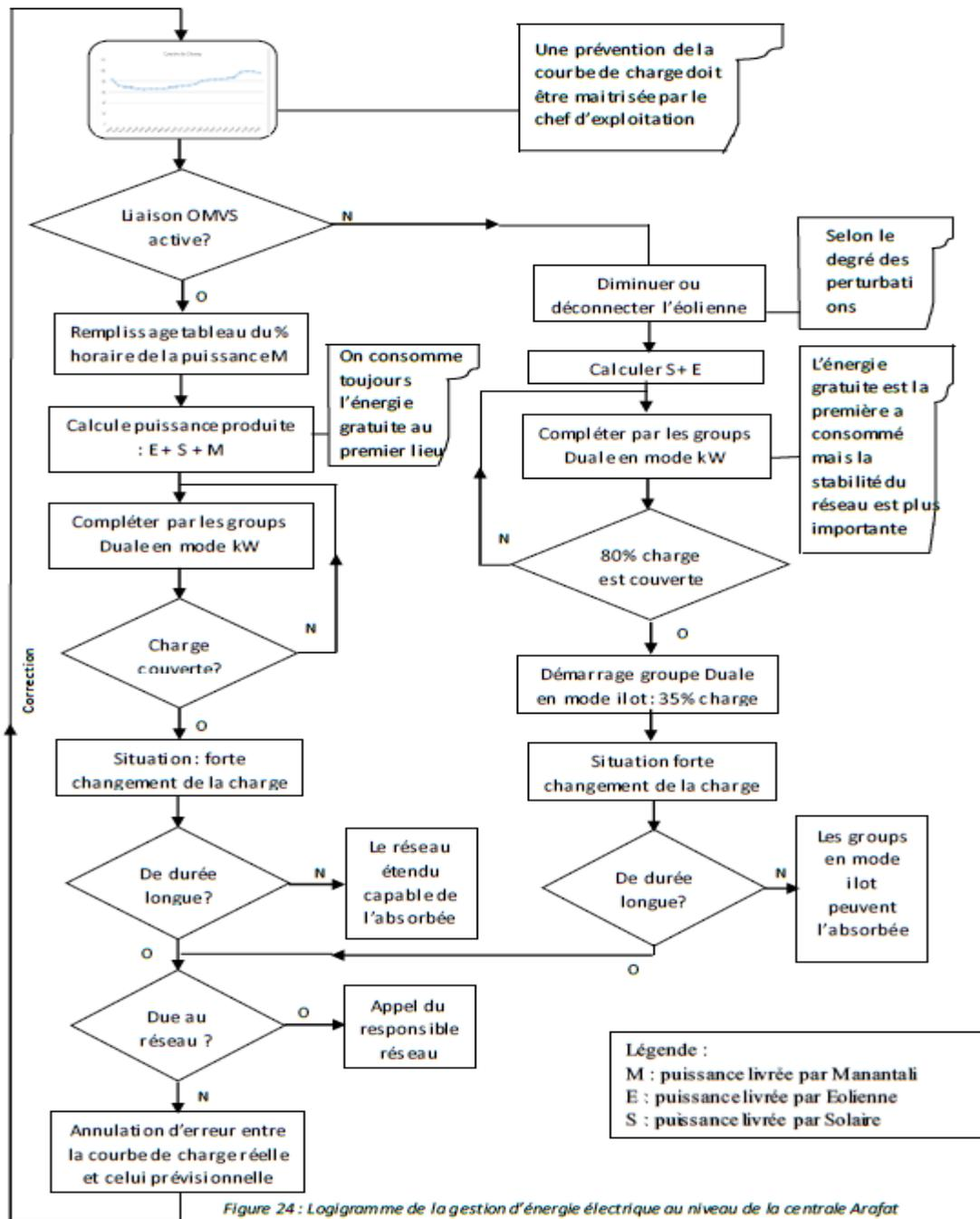
Figure 24 : Logigramme de la gestion d'énergie électrique au niveau de la centrale Arafat
