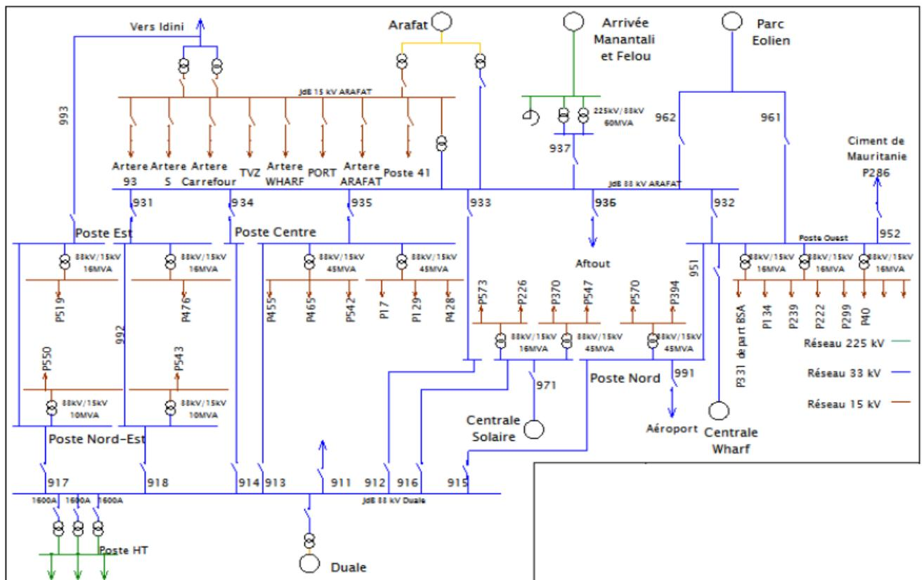
Figure 17 : Schéma unifilaire des du réseau de Nouakchott
