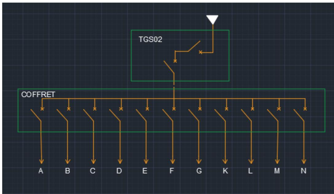
Figure IV.4 : schéma unifilaire d'un niveau.
