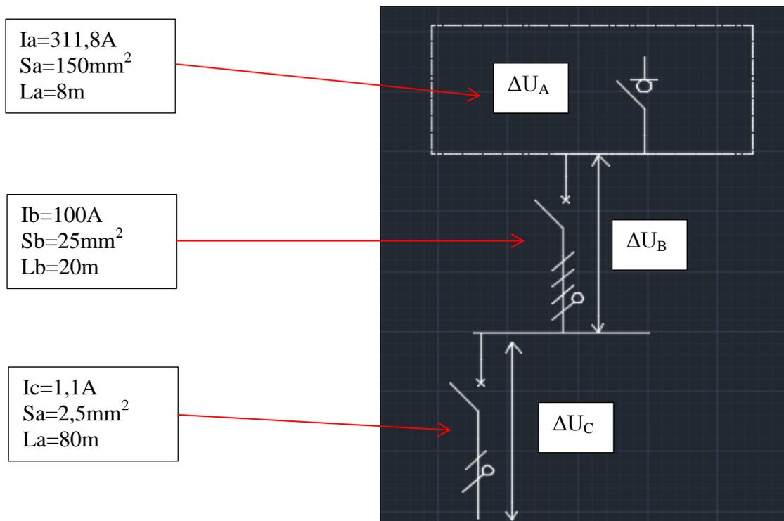
Figure IV.16 : schéma d'étude des chutes de tension.
