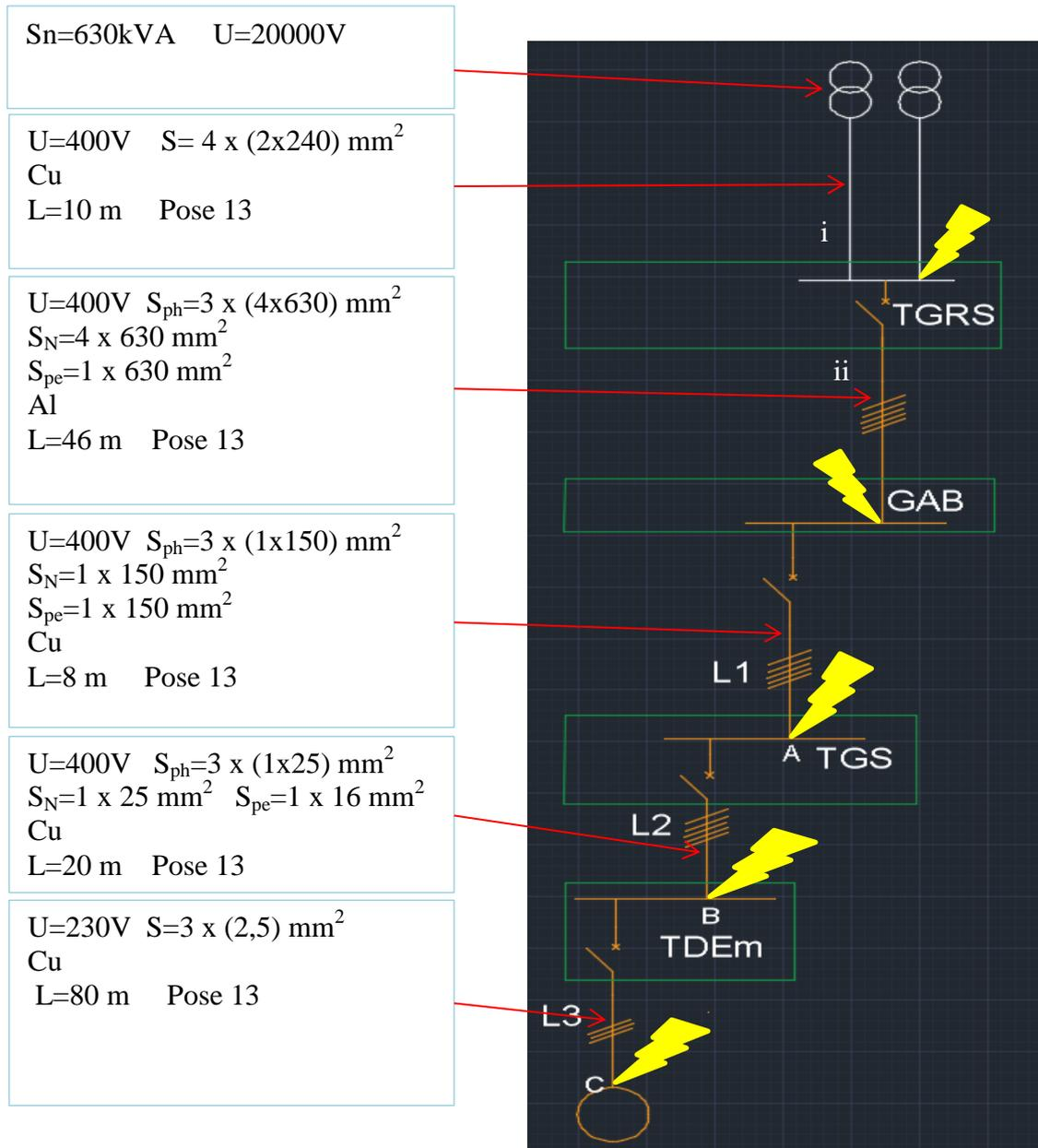
Figure IV.17 : schéma explicitant les différents Icc.
