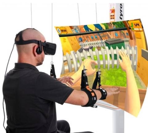
Figure 75 Le dispositif Diego de Tyromotion, peut utiliser la réalité virtuelle immersive en suspension.
