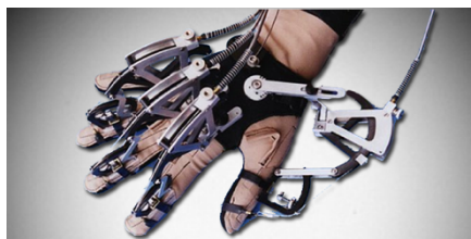
Figure 33 Le Zimmerman VPL DataGlove est un gant de donnée. Il permet l'action dans le jeu et le retour de force pour donner l'illusion du toucher d'un objet attrapé.
