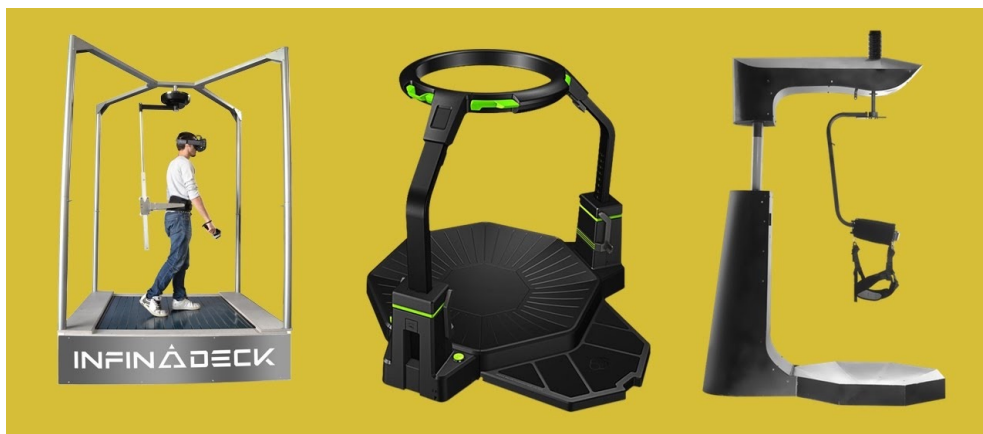
Figure 61 Les plateformes ou tapis multidirectionnels (« treadmills ») permettent un déplacement infini.
