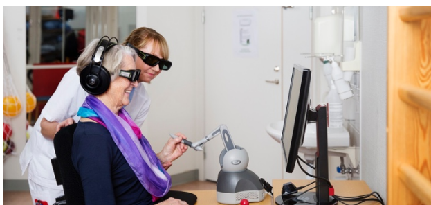
Figure 46 Le système RehAtt utilise une diffusion 3D sur un moniteur, associé à un stylo robotisé.
