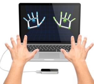
Figure 36 Le Leapmotion permet la capture des mouvements des mains et des doigts.
