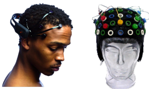
Figure 40 Des interfaces contrôles par le cerveau (BCI) répondant à l'activité neuronale ont commencé à apparaître.
