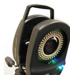
Figure 37 Camera Vicon ® pour la capture professionnelle de mouvement.
