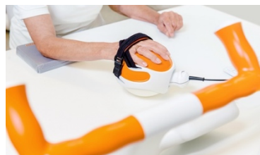
Figure 32 Pablo de Tyromotion dispose d'une centrale inertielle pour capter le mouvement
