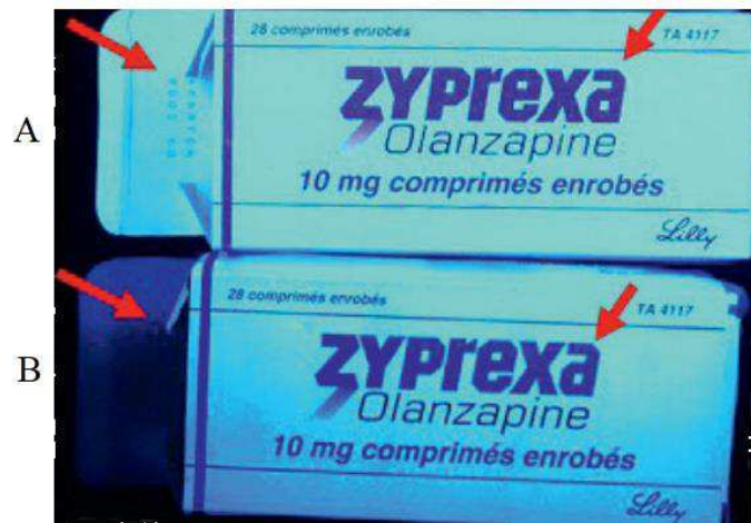
Figure 14 : Observation macroscopique sous lampe UV d'une boîte de zyprexa et mise en évidence d'anomalies de police d'écriture. Échantillon de référence : A ; échantillon suspect : B. (D'après [83]).
