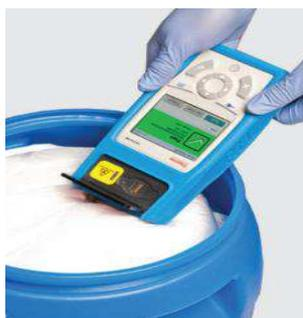
Figure 35 : Spectromètre raman portable Truscan (d'après Usine Nouvelle) [115].
