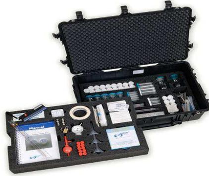
Figure 36 : Kit d'analyse GPHF-Minilab (d'après Global Pharma Health Fund F.V) [116].
