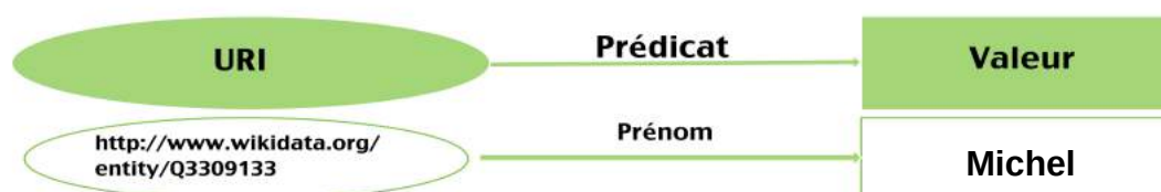
Figure 2 : Schématisation d'un triplet RDF : URI, Prédicat, Valeur. Ce triplet représente l'information « Le prénom de http://www.wikidata.org/entity/Q3309133 est Michel » (Delestre et Malandain, 2017).
