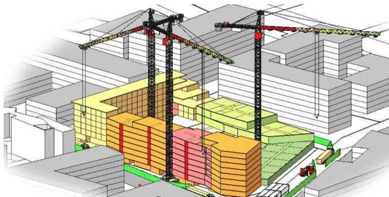
Figure 5 : Installation de chantier et phasage ([10] Methodes btp, 2015)
