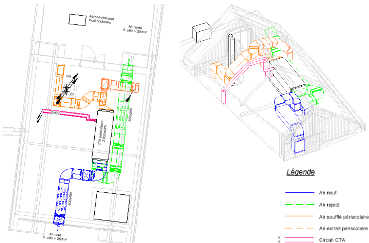
Figure 49 : Péricolaire d'Elsenheim, local technique CTA péricolaire
