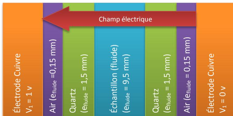
Figure 5 : Schéma des différents diélectriques et leur épaisseur
