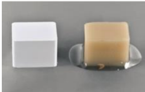
Figure 15 : Bloc de vitrocéramique destiné à être préfritté (à gauche) puis infiltré par une phase résineuse (à droite)
