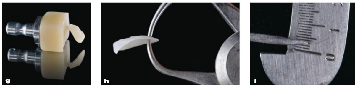
Figure 18 : Photographies d'une table tops en PICN (VitaEnamic) usinée en faible épaisseur (0,2 mm)
