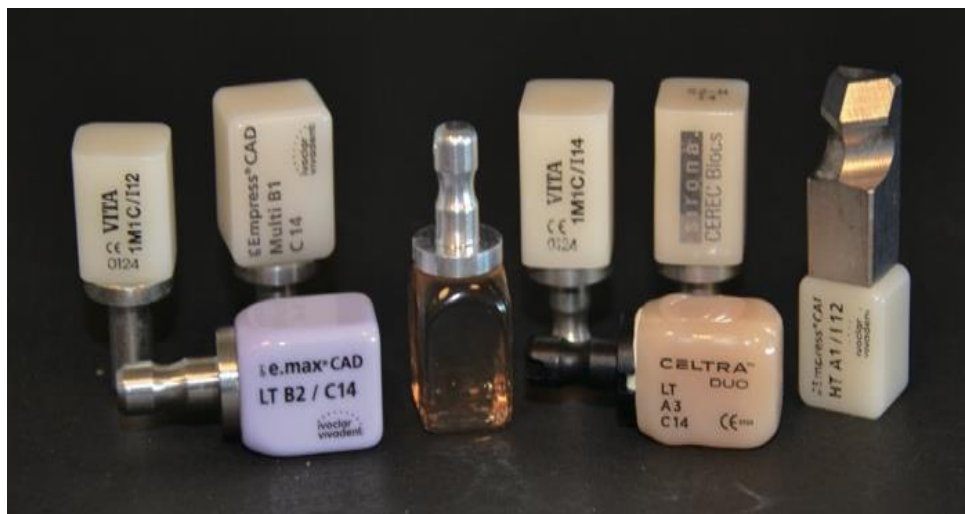
Figure 4 : Différents types de blocs en vitrocéramique pour CFAO directe
