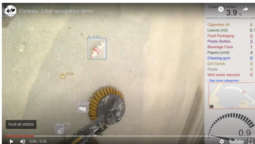
Illustration 8 : L'algorithme permet d'analyser la présence d'une bouteille en plastique sur cette zone –
