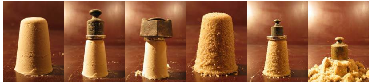
MANIPULATION 64 : Un pâté de sable fin résiste à une charge beaucoup plus importante qu'un pâté de sable grossier.
