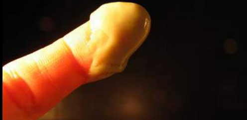
Aspect gélatineux d'une boue de montmorillonite
