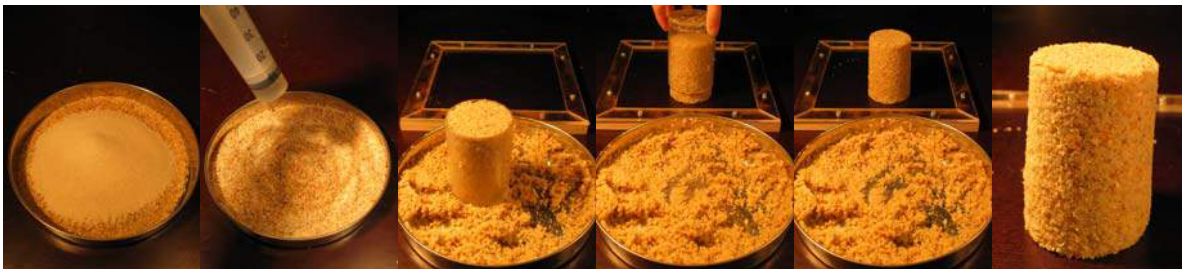
MANIPULATION 66 (SUITE) : Il suffit de mélanger les mêmes graviers à un tiers de sable fin pour obtenir un pâtre résistant.
