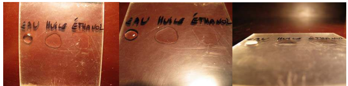
MANIPULATION 51 : Sur le plexiglas, l'éthanol est plus mouillant que l'huile qui est plus mouillante que l'eau.
