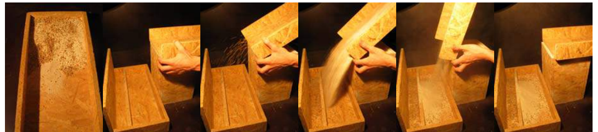
MANIPULATION 33 : Une rampe est remplie d'un mélange de sable et de gravier à son extrémité. Lorsqu'elle est inclinée, le gravier se dépose plus loin que le sable.
