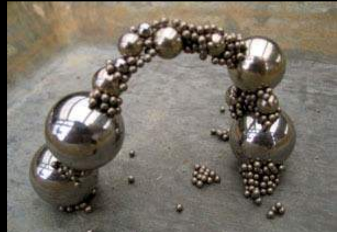
MANIPULATION 34 : Avec des sphères métalliques aimantées, il est possible de construire un arc. En utilisant des billes de même taille, l'arc ne tient pas. En s'aidant avec de petites sphères, on multiplie les surfaces de contact, ce qui permet de faire tenir l'ensemble.
