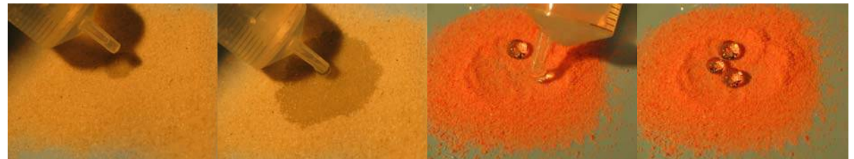
MANIPULATION 67 : L'eau imprègne de sable hydrophile mais forme des perles d'eau à la surface hydrophobe qui reste sec.
