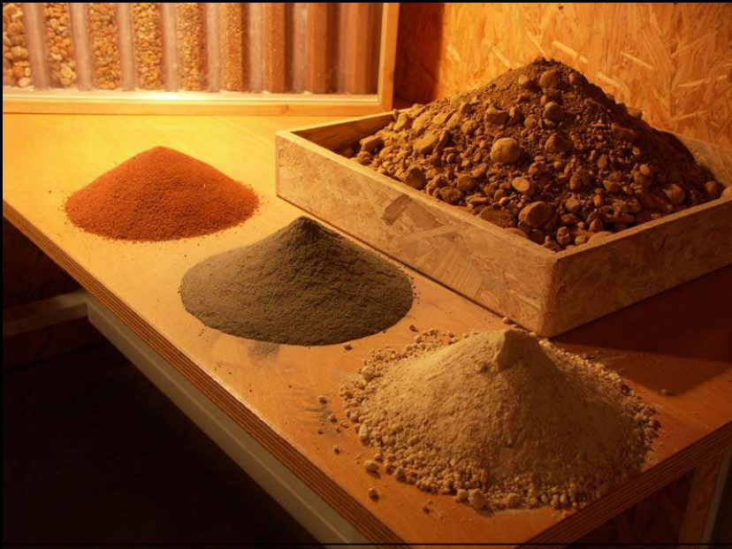
Terres de la régions : terre à pisé marron, terre rouge du Royan, limons noirs de bords d'Isère, terre blanche utilisée pour la commercialisation de sables et de graviers de différentes granularités.
