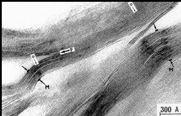
Les smectites, comme les C-S-H, présentent une structure en feuillets. Dans les deux cas, ces feuillets ont une charge surfacique négative.
