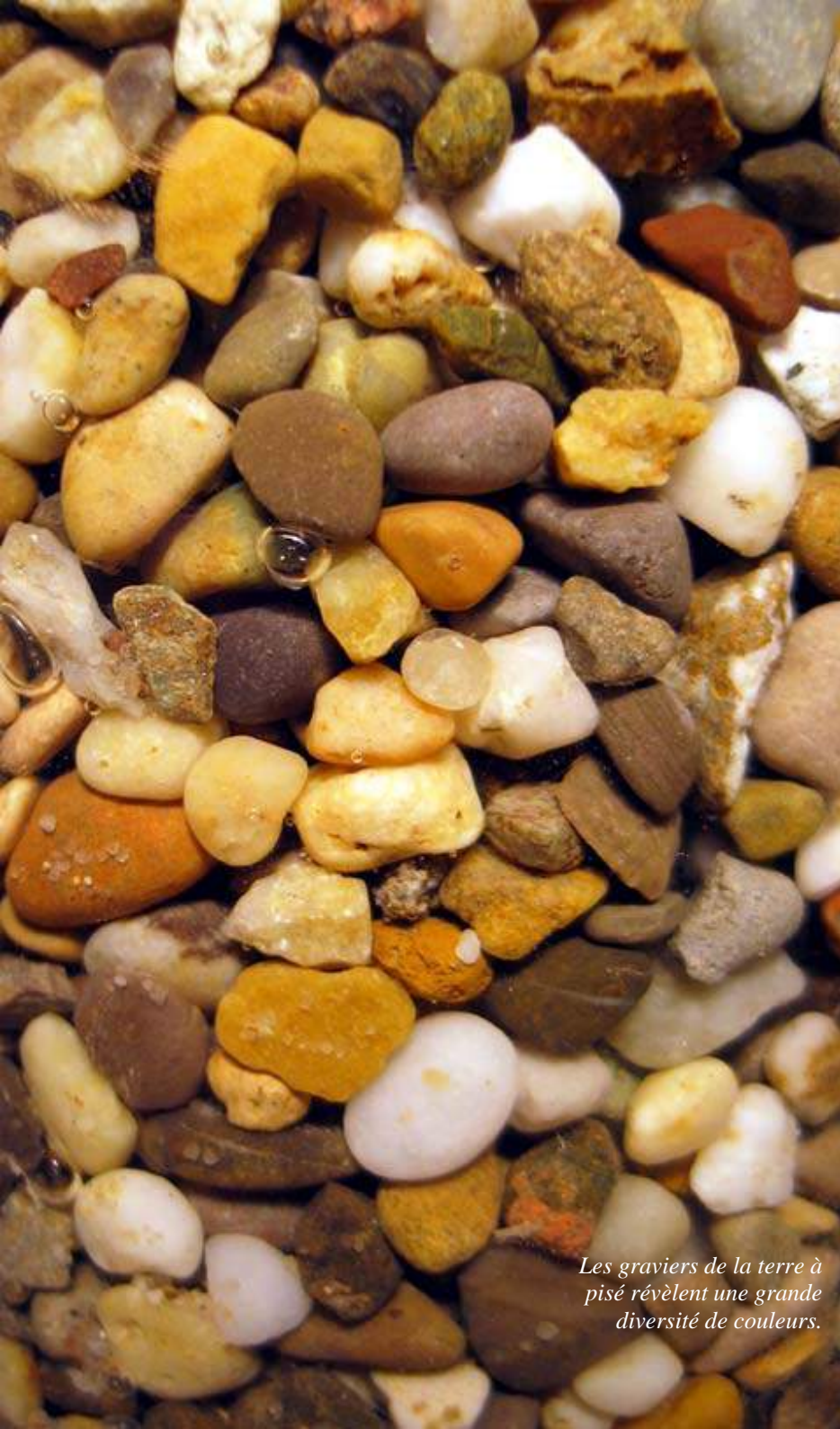
MANIPULATION 2 : Le tamisage par voie humide permet d'observer les couleurs des grains. Des cailloux aux sables fins, les couleurs sont très diverses. Le pot d'argile ressemble à une pâte marron foncée
