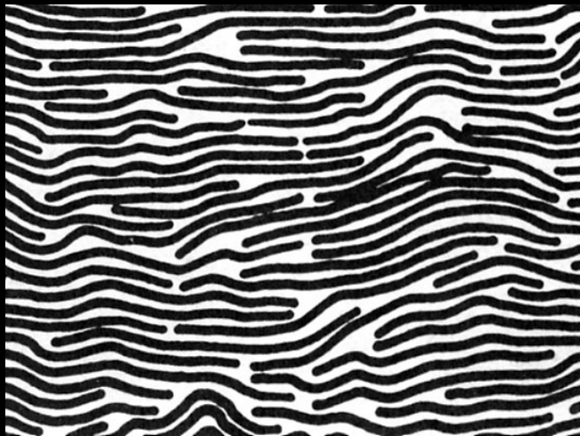
Schématisme de l'état de dispersion des feuillets de smectite dans l'eau.
