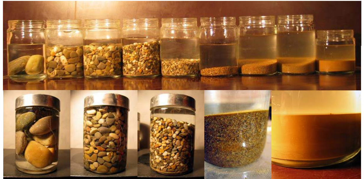
MANIPULATION 2 : Le tamisage par voie humide permet d'observer les couleurs des grains. Des cailloux aux sables fins, les couleurs sont très diverses. Le pot d'argile ressemble à une pâte marron foncée
