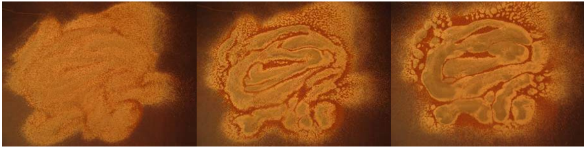
MANIPULATION 32 : La ségrégation se produit également par vibration avec un mélange de grains de différentes tailles. Les particules les plus fines, les plus sensibles à l'effet volcan, se retrouvent au centre, tandis que les plus gros grains, insensibles aux courants d'air, s'étalent sur la plaque.
