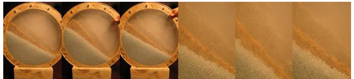
MANIPULATION 20 : La pente du tas dépend des grains qui le constituent. L'angle de repos des billes de verre est plus faible que celui de graviers ronds de même taille, qui est plus faible que celui de grains anguleux.
