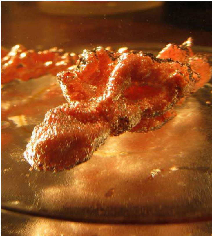
Pellicule d'air autour d'un sable hydrophobe sous l'eau
