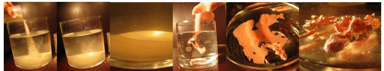
MANIPULATION 67 (SUITE) : Le sable normal se disperse dans l'eau alors que le sable hydrophobe s'agglomère.
