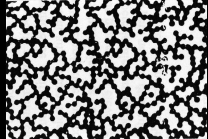
Schématisme d'un réseau de particules colloïdales interconnectées dans un gel.
