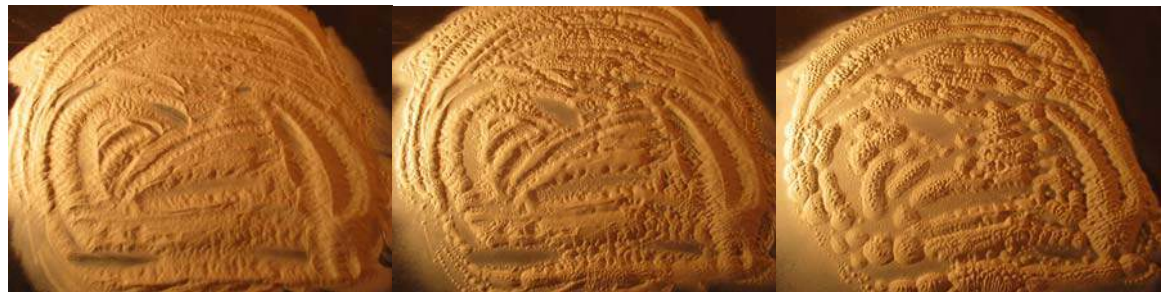
MANIPULATION 24 : Du sable fin étalé sur une plaque vibrante se réorganise de manière spectaculaire pour dessiner des reliefs semblables à des paysages.
