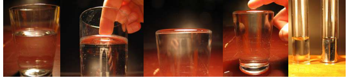
MANIPULATION 52 : À proximité d'un solide, la surface de l'eau se courbe. Les ménisques représentent ces courbures de la surface de l'eau.
