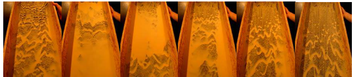
MANIPULATION 6 : Les poudres présentent aussi des analogies étonnantes avec les liquides. Cette poudre silteuse s'écoule sur un support incliné et forme des gouttes similaires à l'écoulement d'un liquide sur une vitre.
