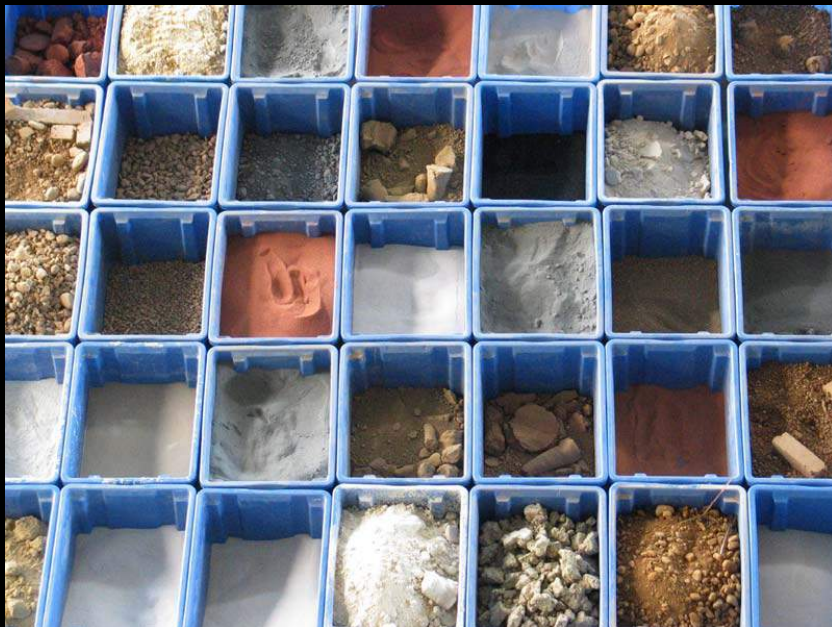
Ensemble de terres dont les grains ont été classés par catégories de tailles.
