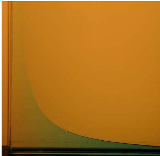
MANIPULATION 54 : Remontées capillaires entre deux plaques de verre très légèrement écartées à droite et en contact à gauche.
