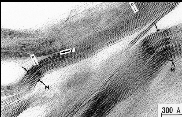
Les smectites, comme les C-S-H, présentent une structure en feuillets. Dans les deux cas, ces feuillets ont une charge surfacique négative. © Van Damme
