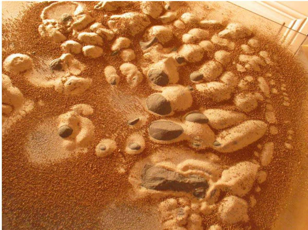
MANIPULATION 32 : La ségrégation se produit également par vibration avec un mélange de grains de différentes tailles. Les particules les plus fines, les plus sensibles à l'effet volcan, se retrouvent au centre, tandis que les plus gros grains, insensibles aux courants d'air, s'étalent sur la plaque.
