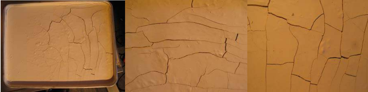
MANIPULATION 91 : Retrait de la kaolinite.
