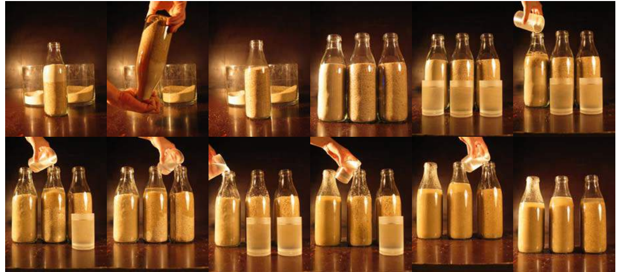
MANIPULATION 73 : En remplissant l'espace poral d'un volume de sable fin, d'un volume de gravier et d'un volume de sable fin et gravier mélangés, on observe que le mélange a la porosité la plus réduite alors que le sable fin et le sable grossier ont des porosités similaires.
