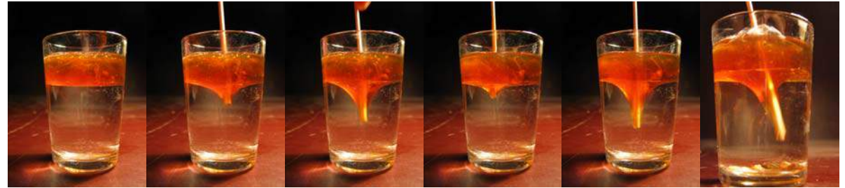
MANIPULATION 46 : De même qu'entre l'eau et l'air, il existe une tension d'interface entre l'eau et l'huile. Dans un verre rempli de ces deux liquides, l'interface apparaît comme une toile tendue élastique qui s'allonge quand on appuie dessus.
