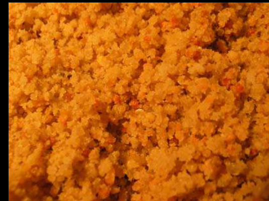
Lorsqu'on humidifie le sable fin et les graviers, on voit les petits grains enrober les plus gros. L'eau empêche les phénomènes de ségrégation.
