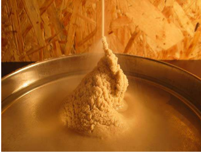
MANIPULATION 42 : Du sable sec s'écoulant dans une nappe d'eau forme une petite colonne semblable à une stalagmite, au lieu de se disperser.
