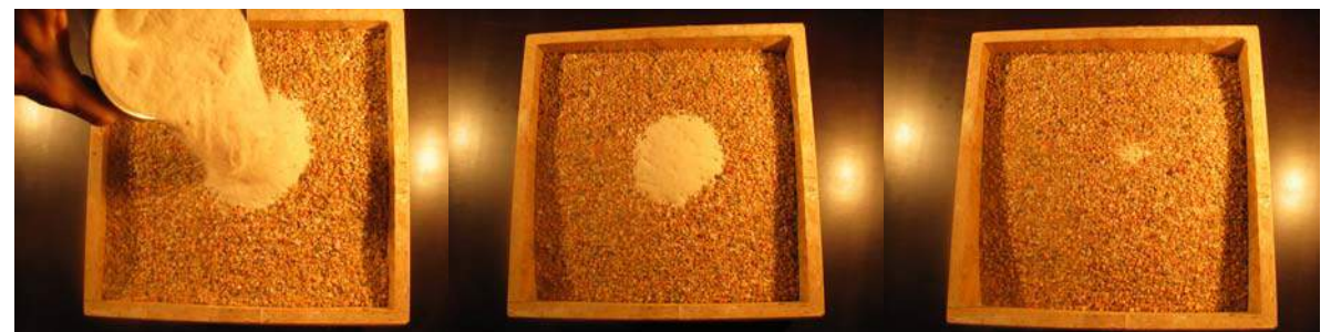
MANIPULATION 13 : Du sable versé sur un lit de graviers disparaît entre les grains
