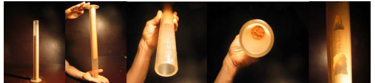
MANIPULATION 37 : Dans un tube où la poudre a été préalablement tassée, en tapant le fond sur une table, l'écoulement se fait par écoulement de strates successives lorsqu'on retourne le tube. Il arrive que la poudre reste bloquée en formant une coupole qui s'appuie sur les parois.
