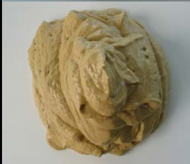
Boue de silt beige (déchet de lavage de la carrière Peysson)
