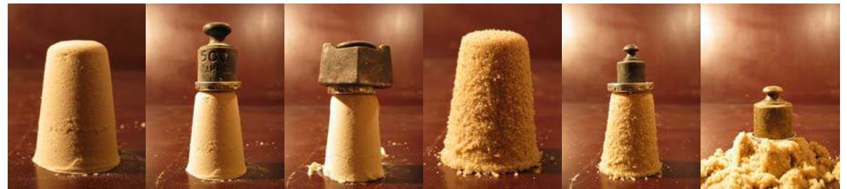
MANIPULATION 64 : Un pâtre de sable fin résiste à une charge beaucoup plus importante qu'un pâtre de sable grossier.
