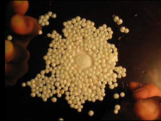
Vue de dessous de la plaque de verre : les petits grains de polystyrène multiplient les surfaces de contact et permettent à l'ensemble de tenir
