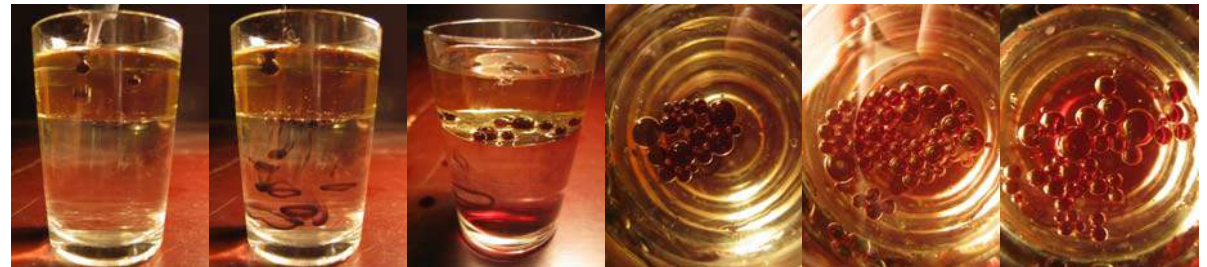
MANIPULATION 48 : Des gouttes d'eau dans l'huile minimisent leurs surfaces en prenant la forme de sphères parfaites.
