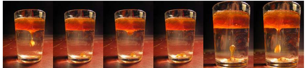
MANIPULATION 47 : On peut visualiser « au ralenti » le passage à travers l'interface huile-eau lorsqu'un objet coule. Dans un premier temps, celui-ci allonge la surface avant de la traverser. Dans la manipulation 43, le poids du trombone est insuffisant pour allonger la surface créée autour de lui.
