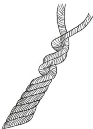
Illustration 2: Schéma d'une corde toronnée. © Chaire ICiMa
