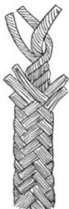
Illustration 3: Schéma d'une corde tressée avec une âme toronnée. © Chaire ICiMa
