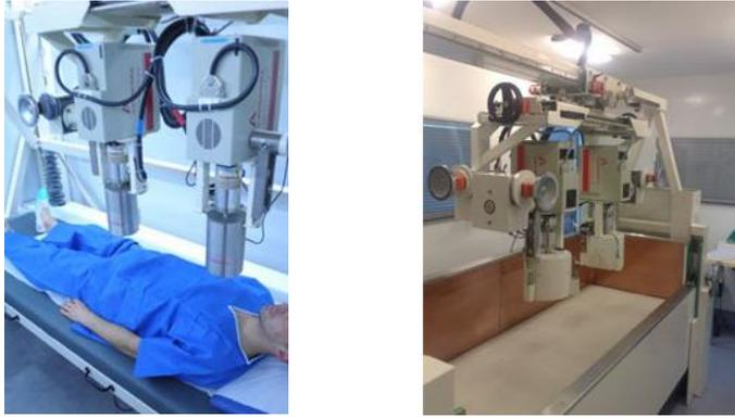
**Figure 3. Appareil d'anthroporadiométrie (source IRSN)**
