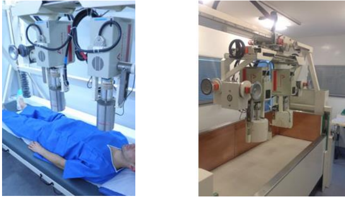
Figure 3. Appareil d'anthroporadiométrie (source IRSN)
