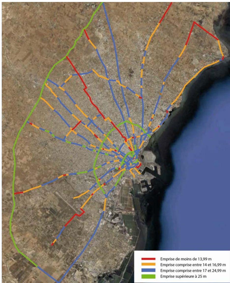
Figure 33 : Largeurs des voiries principales du périmètre d'étude
