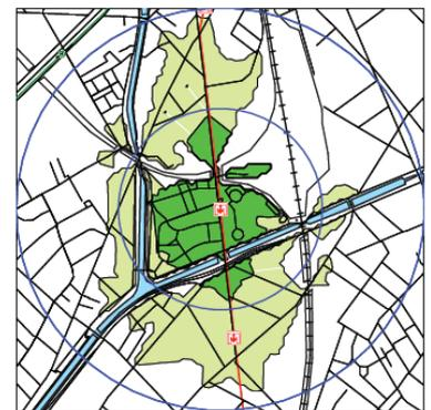
Figure 48 Effet de coupure de canaux avec peu de ponts © Héran, Pouillaude
