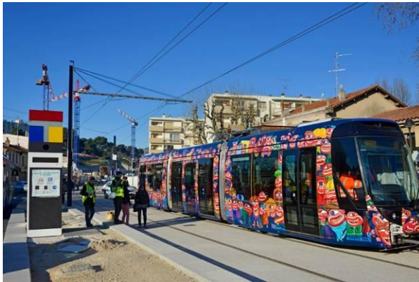
Le Citadis Compact (Alstom) présenté à Aubagne en mars : 3 modules de 2,4 m de large, 22-24 m de long. Capacité de 130 personnes .
