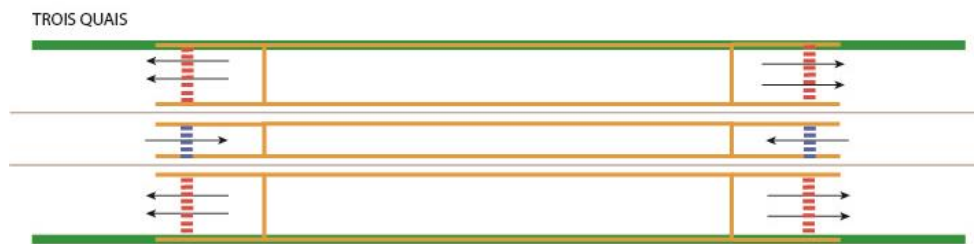
Figure 47 Schéma de la station à trois quais
