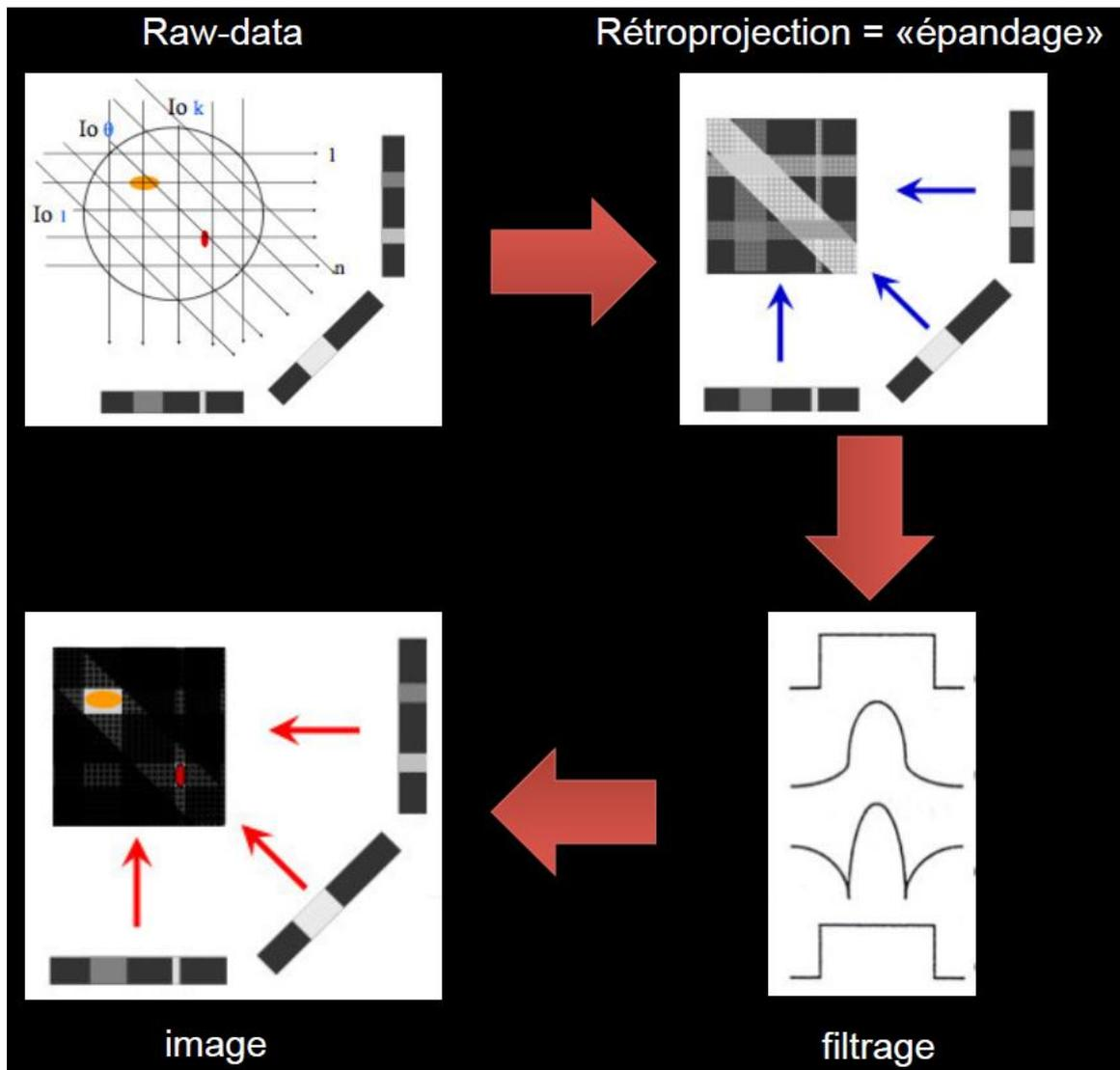
**Figure 1.** Principe de la rétroprojection filtrée [28].
