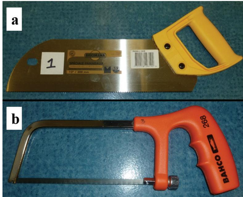
**Fig 2 : Scies à main sélectionnées pour cette étude. (a) Scie universelle ; (b) Scie à refendre.**
